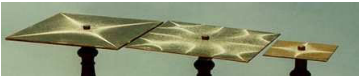
Bild 7: Visualisierung von Schwingungsformen mittels Sandpartikeln (Chladni-Klangfiguren) (aus https://www.leifiphysik.de/atomphysik/quantenmech-atommmodell/versuche/chladni-figuren )
