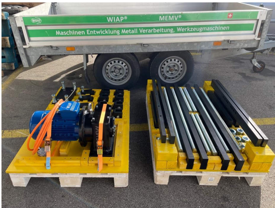
Bild 5: Komplettes Set für 100 Tonnen für die Wellenspannung , Linkes palet V100 Anreger mit Prismenschuh rechtes Palet Tragschienen und Querträger für M36 Befestigung
