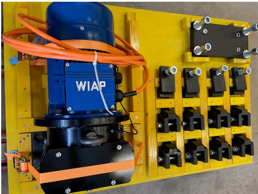
Bild 3: Auf dem Transport Palet sind auch die 8 Stk. Prismenschuhe, eine Zwischenplatte und 4 Stk. Klemmschuhe
