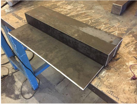
Bild 3: 2 Platten 10 x 240 x 490 mm, S355, wurden zuerst als Einzelhälften zusammen geschweisst.
