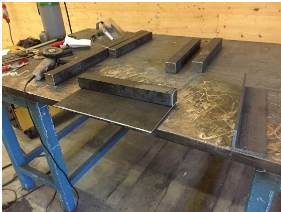
Bild 4: 8 Stück 4-kant Material 60 x 60 x 500 mm, S235.
