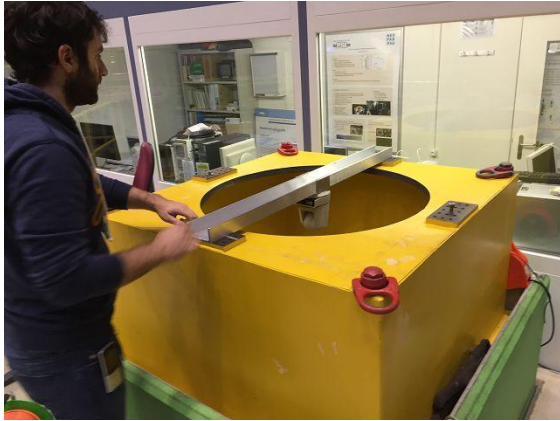
Bild 41: Unten ist das aufgespannte Werkstück. Weil man nicht nach unten sehen darf, ist diese Kamera oben drauf, um den Prozess auch mit prüfen zu können.
