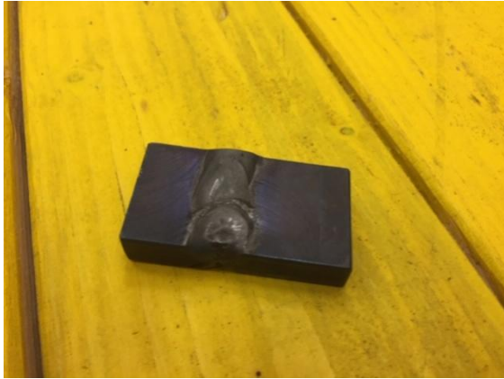
Bild 20: Eichstück, zweite Ansicht wurde mit dem Geglühten mit geglüht.
