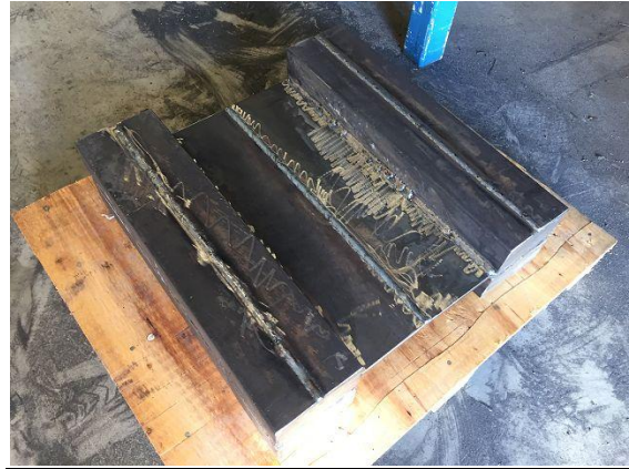
Bild 5: Zusammengeschweisste Hälfte 1 mit der Hälfte 2.
