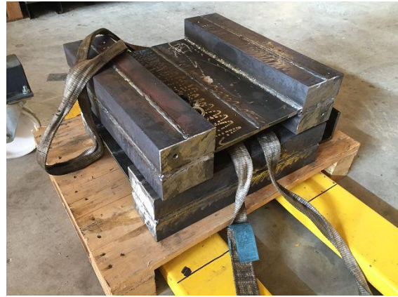
Bild 6: 3 Stück werden hergestellt; je 132 kg schwer. 1 Stück wird nicht spannungsarm gegläht und nicht MEMV® behandelt; 1 Stück wird spannungsarm gegläht. 1 Stück MEMV® behandelt, d.h. Metall entspannt mit Vibration.
