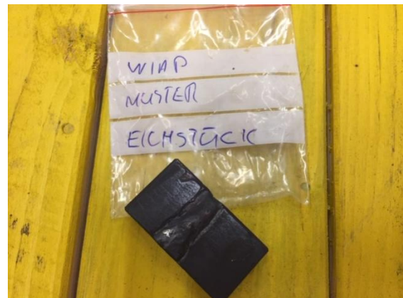
Bild 19: Das Eichstück wurde mit dem spannungsarm geglähten Werkstück mit geglüht.
