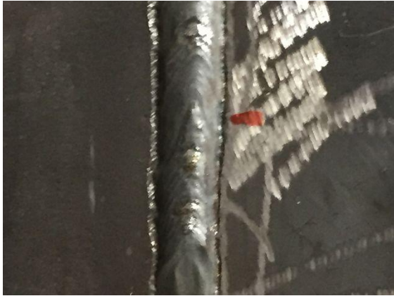
Bild 34: Der Mittelpunkt wird festgelegt. Man misst ab der Mitte 0, -5 und -10 mm und in die Plusrichtung bis + 30 mm; alle 5 mm.
