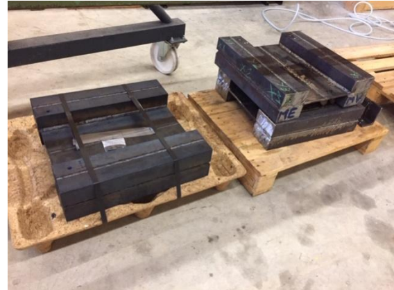
Bild 18: Jetzt sind alle Bauteile bereit. Links das geglähte; rechts oben das WIAP MEMV behandelte; rechts unten das nicht behandelte.
