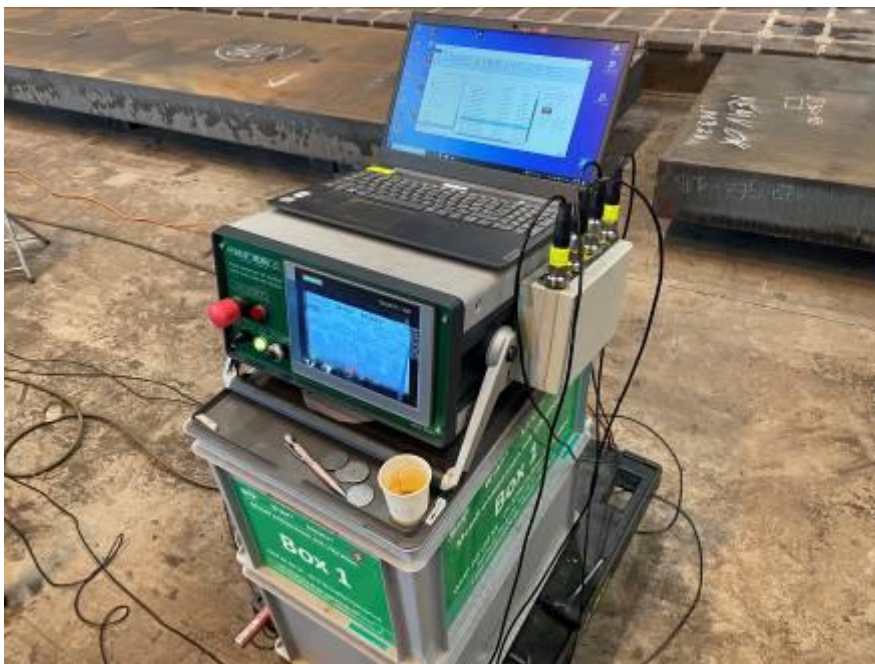
Bild 11L Das Steuergerät sendet das Protokoll auf ein Lap Top oder das Netzwerk. Beide Diese technischen Unterlagen WM 870_B/Zeichnungen_Skizzen und Informationen sind gemäss Art. 2 lit. d des Bundesgesetzes über das Urheberrecht (SR 231.1) unser geistiges Eigentum und dürfen ohne unsere Einwilligung weder kopiert, vervielfältigt, weitergegeben noch zur Ausführung benutzt werden. (SR 231.1) vom 09.10.1992
