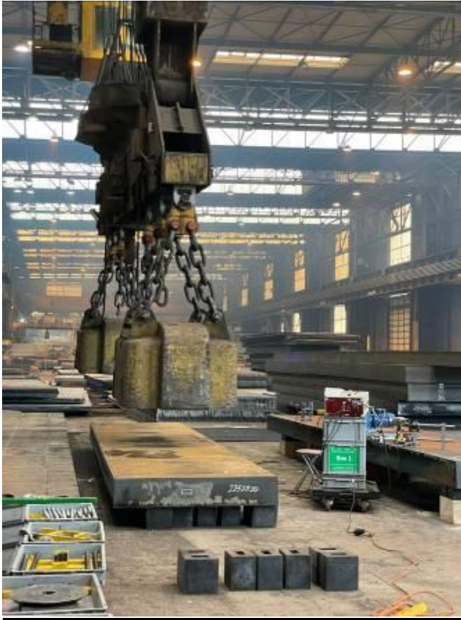
Bild 9A. Schwere Magnete, wobei einer alleine 10 Tonnen wiegt, verschieben die Werkstücke in der Halle des Herstellers.
