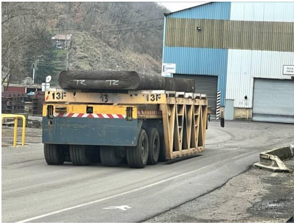
Bild 4A. Transportfahrzeug, das die Rohlinge im Areal befördert. Das Fahrzeug kann sich absenken und auf diese Weise die Rohlinge aufnehmen und transportieren.
