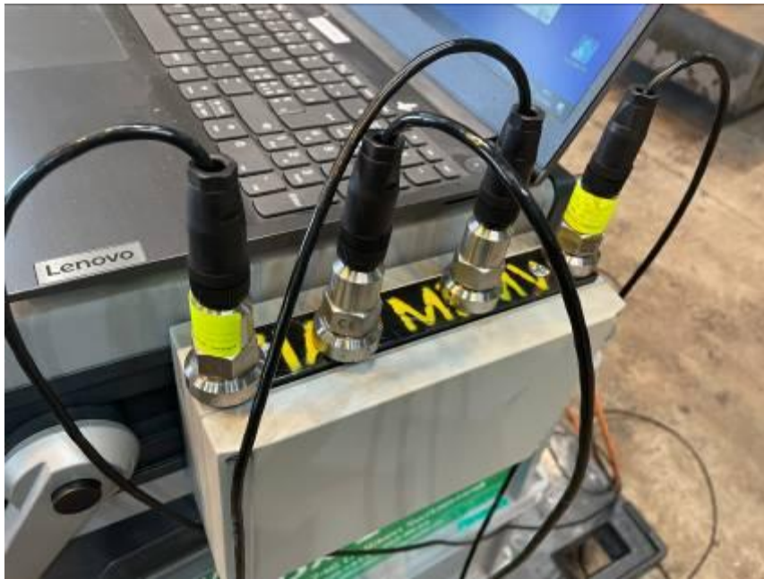
Bild 11K. 4 bis 21 Sonden können am Steuergerät angeschlossen werden. Die gelben markierten sind für die
