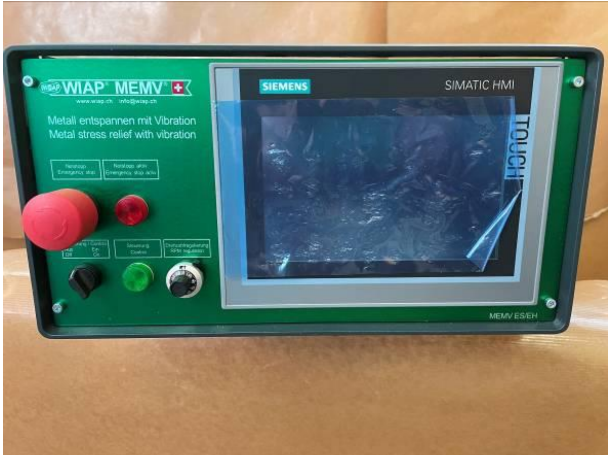
Bild 11A. Ein Steuergerät mit einer Bedienerführung ermöglicht es dem Operateur, Metall mit Vibration zu entspannen.
