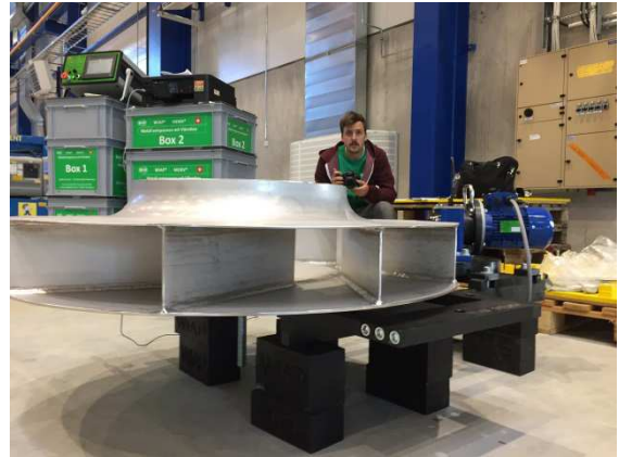
Photo WM838a_7. Der Prozess läuft automatisch. Die Drehzahl wird selber reguliert. Eine Überwachung, welche bei einem Gefahrenwert antastet, automatisch herunter reguliert oder gar in Notstopp auslöst, wenn das Bauteil die Eigenresonanz mit einem zu hohen G wert anregt.
