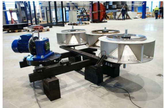
Photo WM838a_8. 3 Impeller Durchmesser 550 mm, Durchmesser auf der Mehraufspannvorrichtung.
