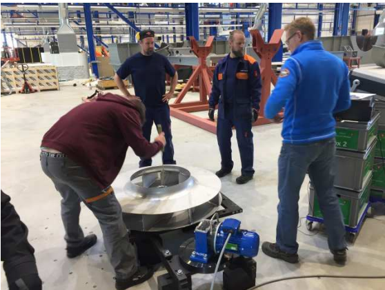
Photo WM838a_6. Status Vermessung der Anreger Achsen, was die X = Transversalwellen, Z = Longitudinalwellen, Y = Quer- oder Schubwellen senkrecht machen. Es wird ein Protokoll erstellt mit allen Positionen, nebst dem über das Steuergerät.
