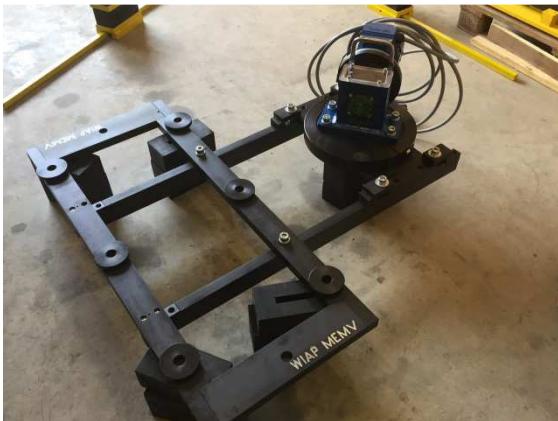
Photo WM838a_1. Mehrfachauspannvorrichtung für 6 x 330 mm Durchmesser, oder 3 x 550 mm oder 1 x 900 mm. System für die Nabenspannung.
