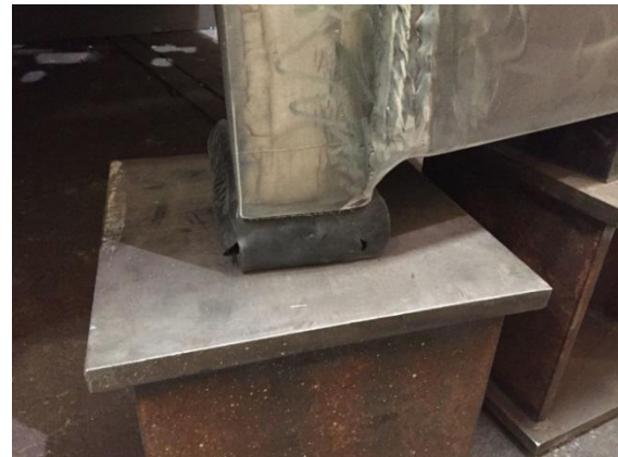
Image 13 : Ici, les 60 % de compression du caoutchouc ont été atteints, il faut en éviter davantage.
