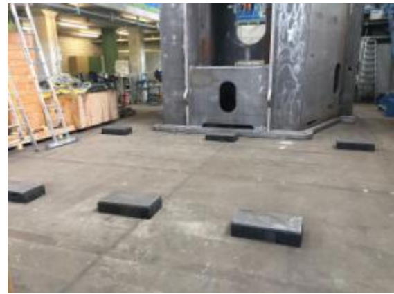
Figure 9 : Patins en caoutchouc pour 110 tonnes : (Voir plus de détails dans le rapport WM877 60 tonnes).
