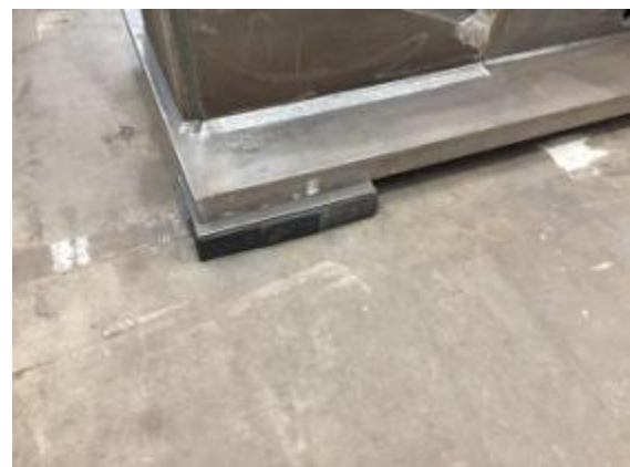
Figure 9 : Patins en caoutchouc pour 110 tonnes : (Voir plus de détails dans le rapport WM877 60 tonnes).
