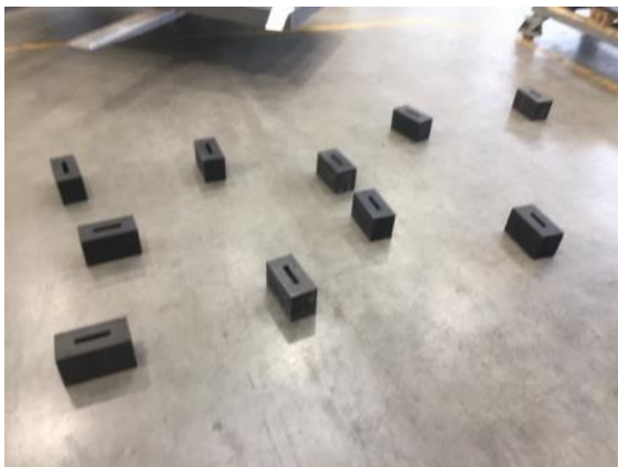
Figure 2 : Vibration de la plaque. Coussinets en caoutchouc suffisants 100x200x120 10 pcs.
