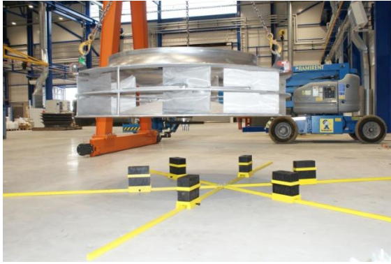
Image 5 : La turbine lorsqu'elle est placée sur les patins en caoutchouc sécurisés.
