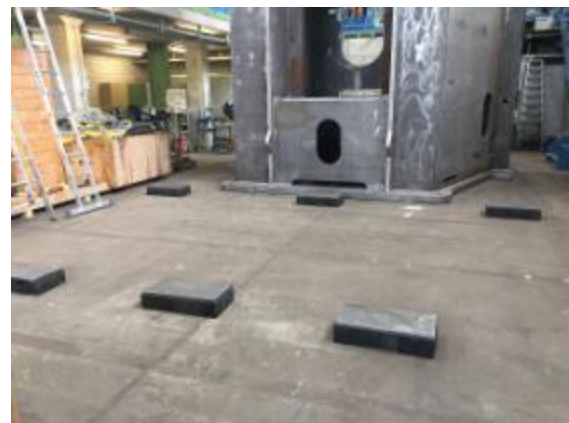
Figura 9: Tamponi in gomma per 110 tonnellate: (Vedi maggiori dettagli dal rapporto WM877 60 tonnellate).
