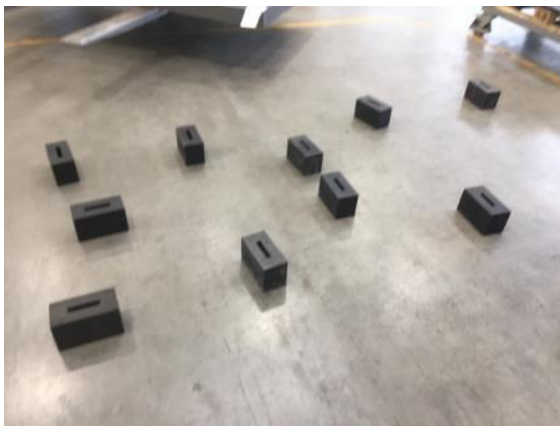
Figura 2: vibrazione della piastra. Tamponi in gomma sufficienti 100x200x120 10 pz.
