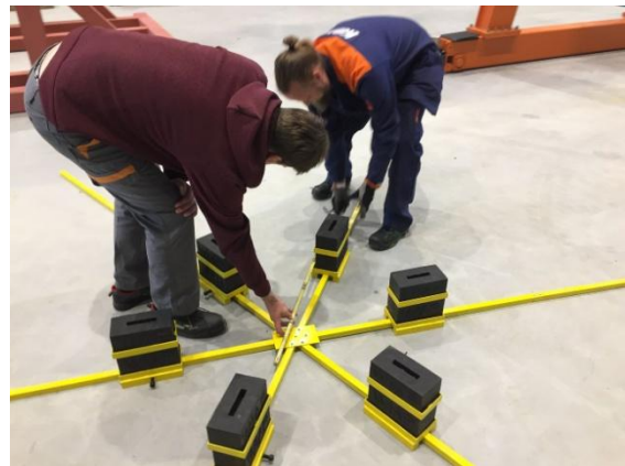
Immagine 4: Il WIAP® MEMV® 6 - Il dispositivo di supporto a stella è posizionato nelle posizioni del supporto di diametro 1300 mm. Ciò impedisce che i cuscinetti in gomma si allontanino durante i movimenti di risonanza. Nella migliore delle ipotesi, anche che gli operatori ne impediscano il ribaltamento calpestando la girante. Il diametro esterno della girante era di 1500 mm; la gomma ha un raggio di 650 mm.
