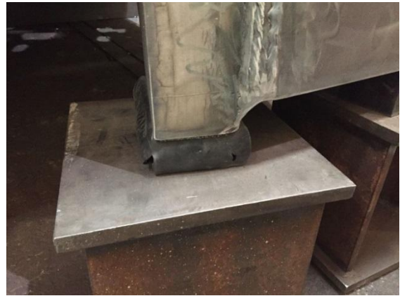
Immagine 13: Qui è stato raggiunto il 60% della compressione della gomma, si dovrebbe evitare di più.
