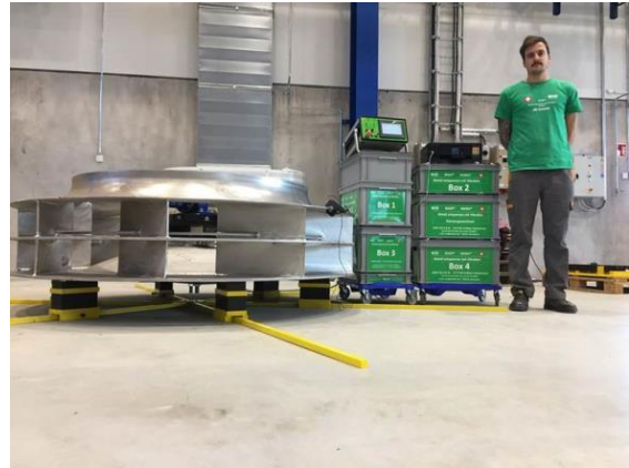
Immagine 3: WIAP® MEMV® rilassarsi dalla girante duplex. Jim Peter Widmer con l'unità di controllo completamente automatica WIAP MEMV E e la stampante registra le misurazioni prima e dopo.
