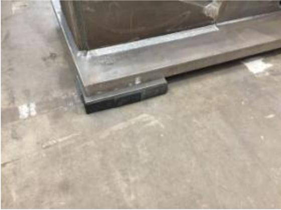
Bild 10: Gummiunterlagen 300 x 600 mm
