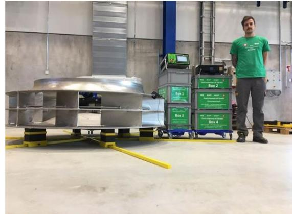
Bild 3: WIAP® MEMV® entspannen von Duplex Impeller. Jim Peter Widmer mit dem WIAP MEMV E vollautomatischem Steuergerät und Drucker protokolliert Messung vorher und nachher.
