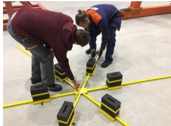
Bild 4: Die WIAP® MEMV® 6-Sternauflegevorrichtung wird in die Positionen der Auflage 1300 mm Durchmesser eingestellt. Es wird damit verhindert, dass die Gummiauflagen bei Resonanzbewegungen wegwandern können. Allenfalls auch, dass die Operateure beim Betreten des Impellers ein Abkippen verhindern. Der Aussen-Durchmesser des Impellers war 1500 mm; den Gummi hat man im Radius auf 650 mm festgelegt.
