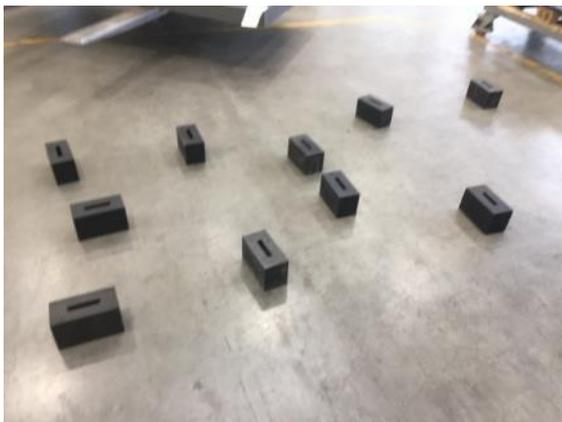
Bild 2: Platten Vibrieren. Genügend Gummi Unterlagen 100x200x120 10 St.
