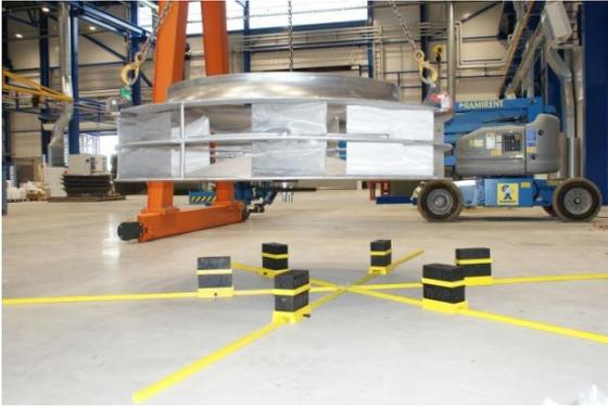
Bild 5: Der Impeller beim Aufsetzen auf die gesicherten Gummiauflagen.
