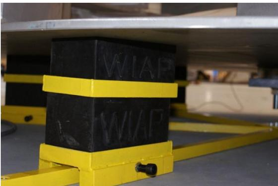
Bild 7: Hiermit wird das Wegrutschen, wenn eine Eigenresonanz überfahren wird und allenfalls ein zu langes, starkes Vibrieren einsetzt, gesichert.
