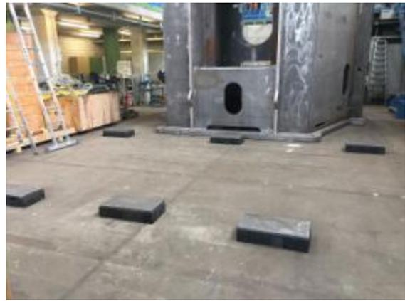
Bild 9: Gummiunterlagen für 110 Tonnen: (Siehe mehr Detailinformationen aus dem Bericht WM877 60 Tonnen).
