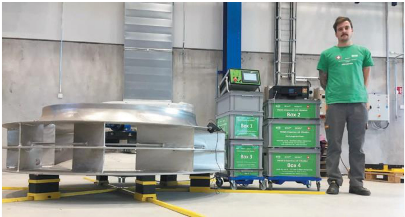
Obrázek 1. Jim Peter Widmer před strojem MEMV („Metall entspannen mit Vibration“ = „Zařízení pro odstraňování pnutí vibracemi“) - investice WIAP AG - (hpw - Hans-Peter Widmer)
