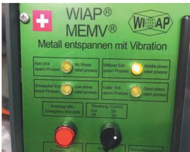
Obrázek 23. Řídicí jednotka WIAP MEMV E, Safenwil (hpw)
