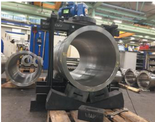
Obrázek 7. Test duplexní trubky - (hpw)
