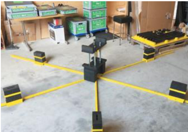
Obrázek 17. Hvězdicový pryžový držák s montážním zařízením pro axiální stimulátor - (hpw)
