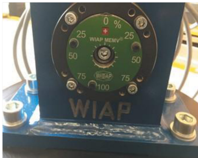
Obrázek 14. Nový stimulátor V20 s různými možnostmi nastavení v% pro různé excentrické fáze - (hpw)
