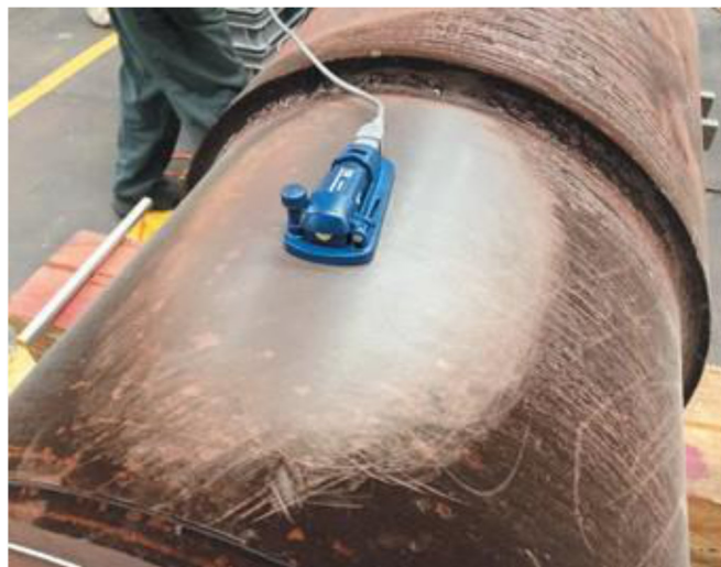
Obrázek 9. Test měření pomocí datového záznamníku: Žíhaná podložka - (hpw)
