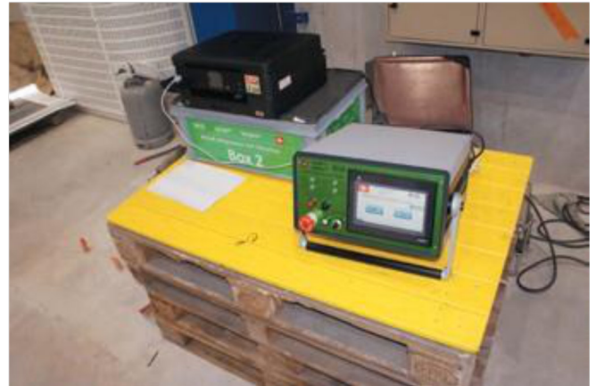
Obrázek 24. Řídicí jednotka WIAP MEMV s tiskárnou a boxy, - (jw)
