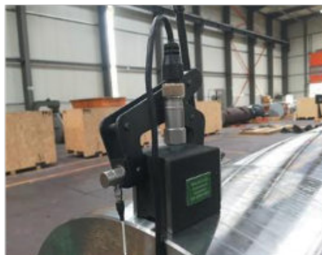
Obrázek 28. Měřicí sondy MEMV - (jw)
