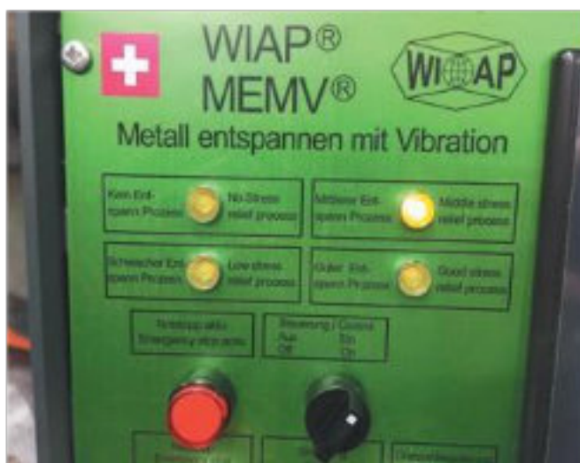
Obrázek 23. Řídicí jednotka WIAP MEMV E, Safenwil (hpw)
