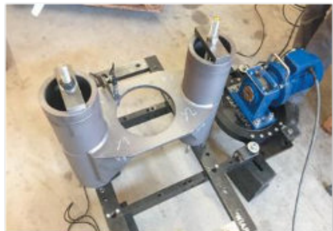
Obrázek 21. Vicensobné upínací zařízení, zákaznický dílec - (hpw)
