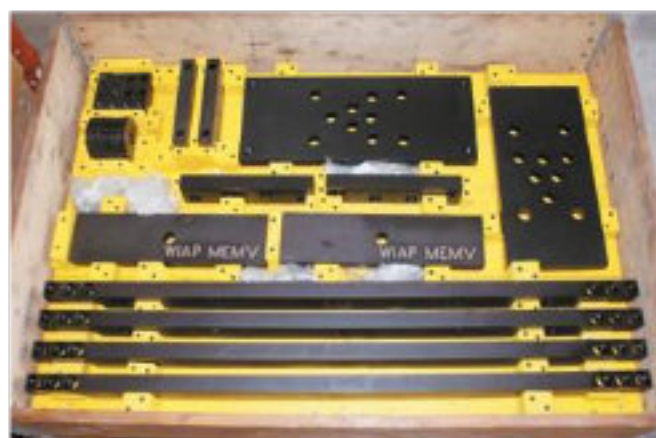
Obrázek 15. Upínací zařízení - axiální, pro oběžné kolo - (hpw)
