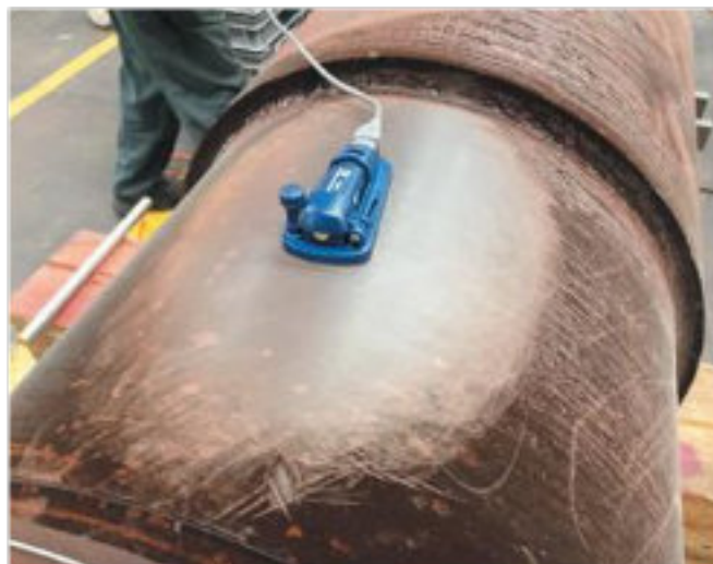
Obrázek 9. Test měření pomocí datového záznamníku: Žehaná podložka - (hpw)
