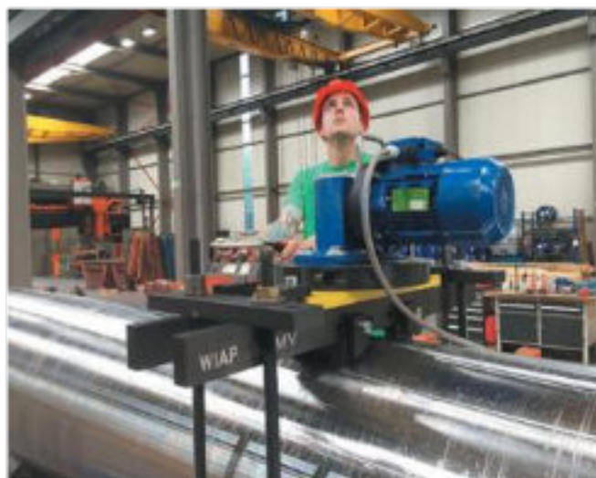
Obrázek 5. Válcování se snižováním pnutí vibracemi (MEMV) - Jim Peter Widmer - (hpw)
