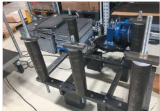
Obrázek 20. Šestiválcové trubky provicenasobné upínací zařízení - (hpw)
