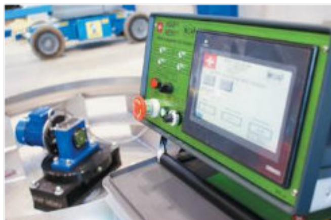
Obrázek 26. Řídicí jednotka WIAP MEMV se stimulátorem V20 v pozadí - (jw)
