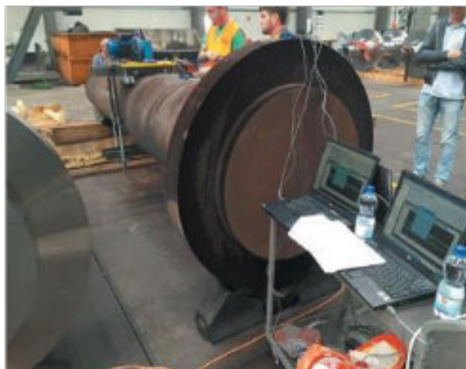
Obrázek 10. Test měření s několika datovými záznamníky včetně následného protokolu - (hpw)
