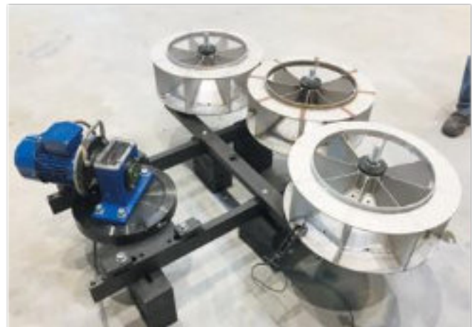
Obrázek 19. Tři oběžná kola o průměru 800 mm na více přípravcích, - (hpw)
