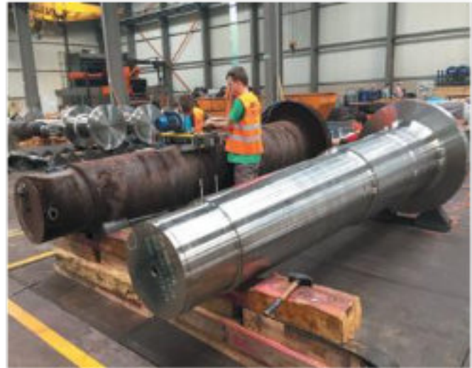
3.kép: Jim Peter Widmer egy hőkezelt ésegy hőkezeletlen tengely előtt -2016 október (hpw)
