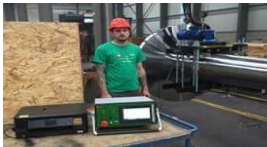
Rullo senza ricottura nella distensione sotto vibrazione
