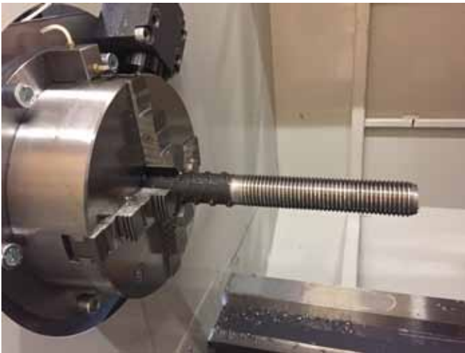
Bild 2 Komfortabel zum fertigen Werkstück, hier ein Gewinde M36x4 mit 180 mm Länge: Die Berechnung des Programmlaufes erfolgt vollautomatisch über Parameter. Der Werker muss lediglich Gewindedurchmesser, -länge und -steigung sowie die Länge des Werkstücks eingeben
