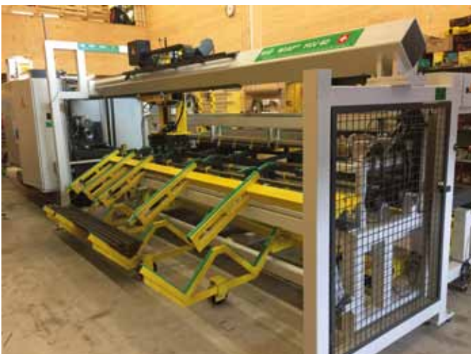
Bild 3: Ordentlich sortiert: Die automatisch bearbeiteten Werkstücke gelangen zum Ende des Prozesses wieder auf einer Ablage für bis zu 50 Teile (Werkbilder: WIAP AG, CH-Dulliken)
