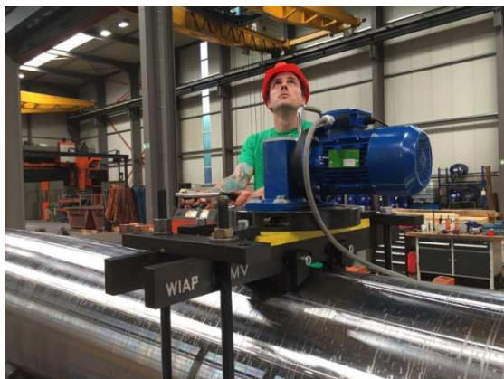
Walzen beim Metall entspannen mit Vibration (MEMV) – Jim Peter Widmer – April 2017 (hpw)
