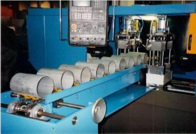
Alles ist schnell umstellbar. Beidseitig wird das Rohr plangedreht und auf einer Seite gibt es einen Bund mit einer Nase, wo ein Teil darauf gelötet wird. Die Toleranz ist klein. WN\_930\_60
