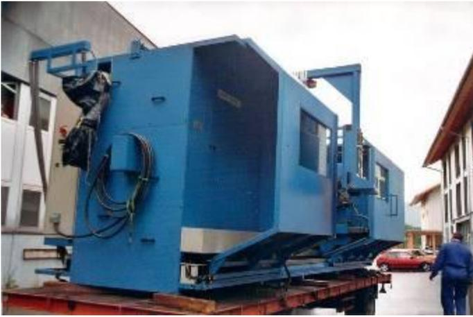
Diese WIAP DM4C wurde für einen Schweizer Kunde gebaut. Die Maschine hat ein Schwingdurchmesser von 2000 mm und es sind 2 X-Schlitten unabhängig verfahrbar. WN\_900\_80
