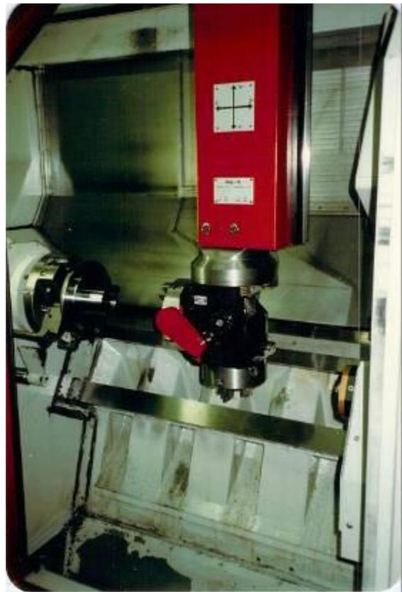
Der Schwenkgreifer mit selbsthaltendem Greifer, wenn Stromunterbruch, dass das Werkstück nicht herunter fallen kann. Der Greifer kann 0 und 90° zuzüglich 180° Drehbewegung. WN\_1220\_40
