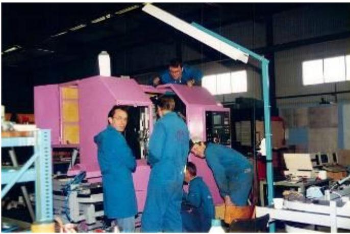
Die WIAP Vertikal CNC Drehmaschine. Kompakt und geeignet für Futterteile von 45 mm bis 160 mm. Ideal 100 mm Werkstück Länge. WN\_910\_340
