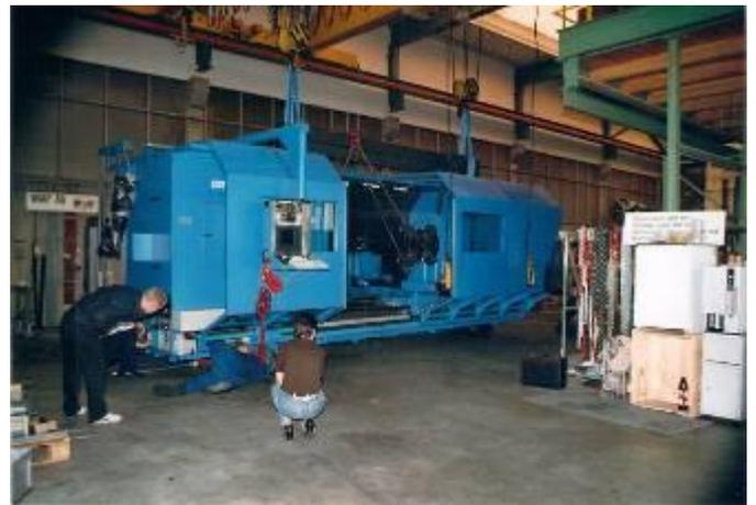
Diese WIAP DM4C hat einen Schwingdurchmesser von 2000 mm und zwei einzeln verfahrbare Revolver. 3 Späneförder, Maschinen Nummer 10032, Maschinengewicht 23 Tonnen. Besonderheit zwei einzeln verfahrbare Werkzeug Revolver. WN\_900\_10
