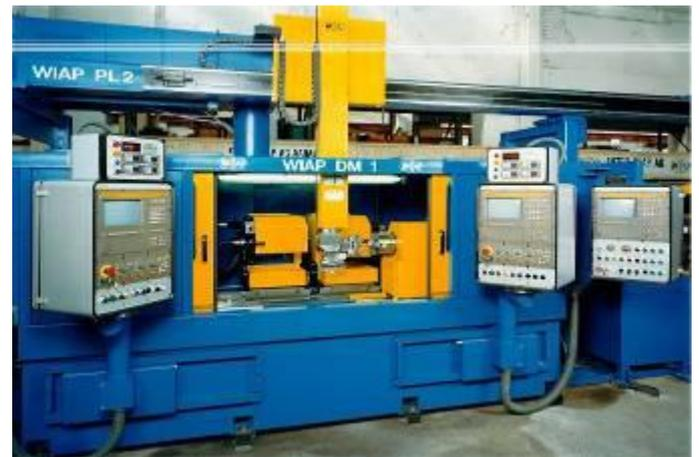
Doppelseiten-CNC-Drehmaschine WIAP DM2A. Zwei Revolver. Zwei verfahrbare Spindelstöcke. Eigener Portallader WIAP PL 2 für 2 x 7 kg Werkstückgewicht. WN\_920\_10
