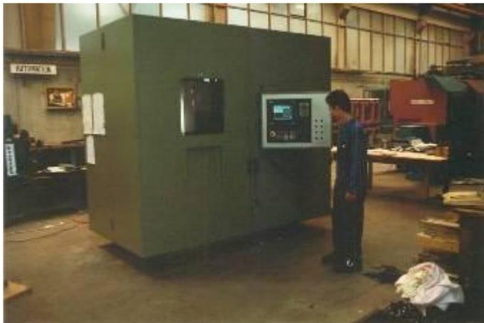
Diese Sonderdrehfräsmaschine Wiap DM2\_XP war für einen Grosskonzern. Sie konnte drehen und fräsen mit 20'000 Umdrehung. Gleichzeitig eine Drehspindel, die mit einem Plandrehkopf dreht. Die gesamte Konstruktion war von der Wiap. Das war eines der anstrengten Projekten, das die Wiap je ausführte. Taktzeit ein Teil in 2 Sekunden. Und ein sehr exakter Kunde, der die Sekunden halbierte. WN\_970\_10
