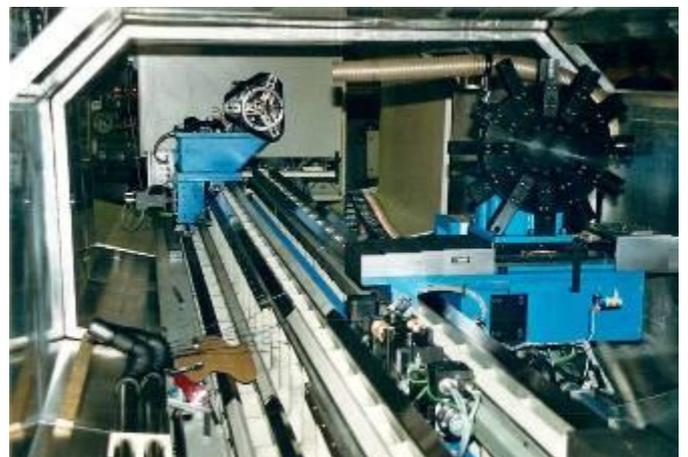
8 Führungen für zwei Spindelstöcke; zwei Z-Kreuzschlitten; zwei Zentrierlunetten. WN\_960\_40
