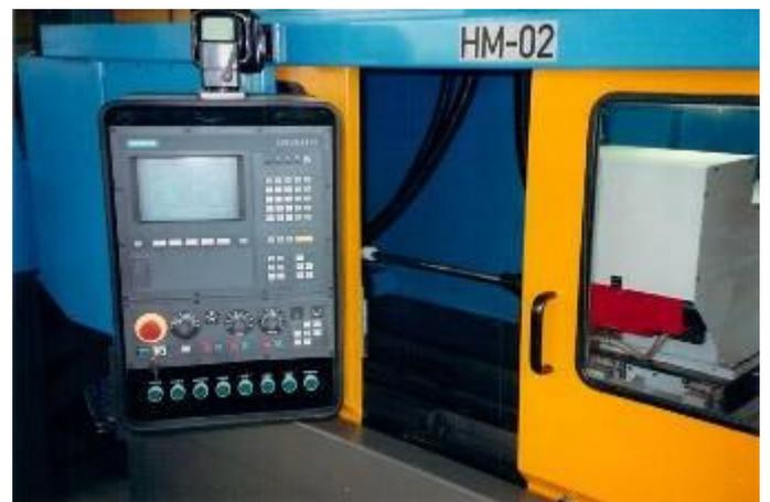
Die CNC Steuerung ist eine Sinumerik 810T GA2. WN\_940\_20
