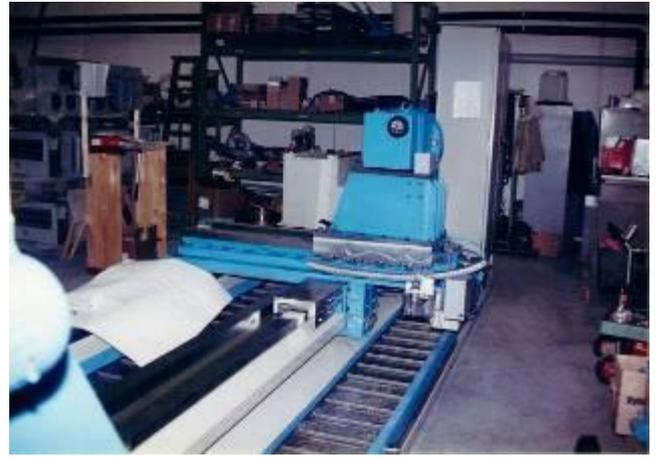
Die Maschine hat 2 Späneförderer. Führungsbreite in X- und Z 90 x 50 mm und über 60 HRC einsatzgehärtet. Die Führungen können ausgetauscht werden, allenfalls nur umdrehen, dass der verschlissene Teil hinten ist. WN\_900\_120
