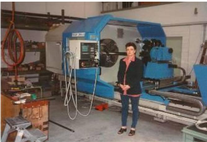
Diese WIAP DM4C hat einen Schwingdurchmesser von 1600 mm. Ein 15 Grad schräggestellter 12-fach Scheibenrevolver und 200 mm Spindeldurchlass. Maschinengewicht 16 Tonnen. Konstruktion und Herstellung WIAP. Maschinen Nr.10025. WN\_900\_90
