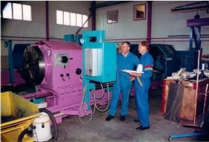
Diese WIAP DM4C hat einen Schwingdurchmesser von 1300 mm. Ein 12-fach Scheibenrevolver und 265 mm Spindeldurchlass, Maschinengewicht 13 Tonnen. Konstruktion und Herstellung WIAP. Maschinen Nr.10020. WN\_900\_200
