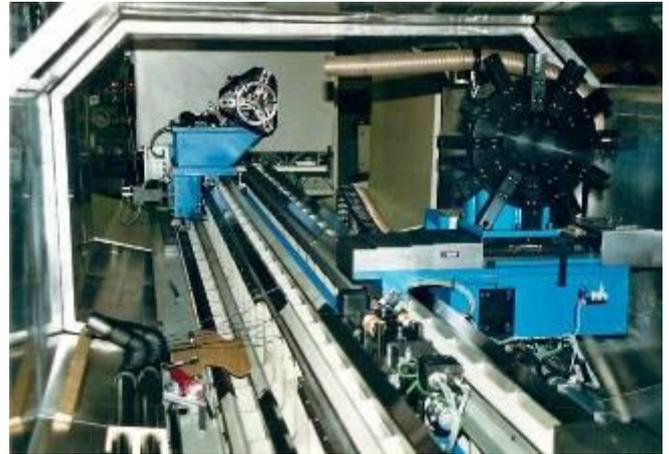
Die Wiap DM2 XA Maschine ist eine Sonderausführung mit 8 Führungsbahnen. 4 Schlitten, die kollisionsfrei vorbei fahren können. WN\_960\_10
