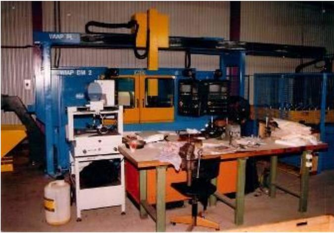
WIAP DM2A CNC Drehmaschine mit dem Portallader WIAP PL2 während den Drehversuchen. WN\_920\_50
